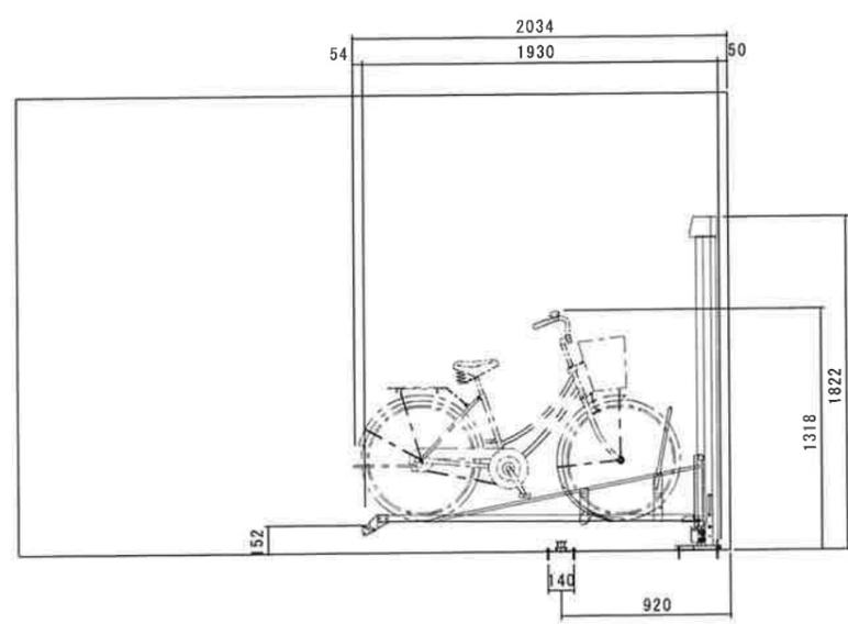
上段操作時 側面図 S=1/30
